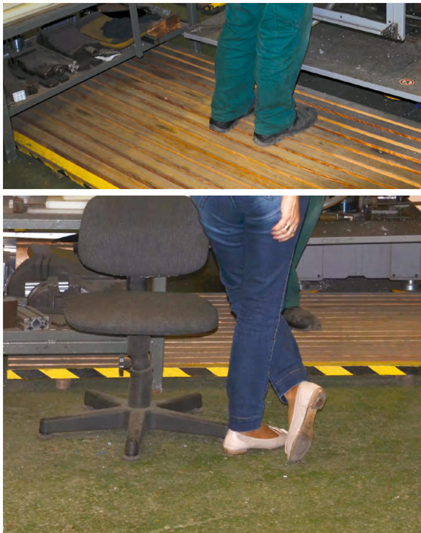
Rys. 74-1. Krawędzie podestu przy maszynie oznakowane barwą bezpieczeństwa
