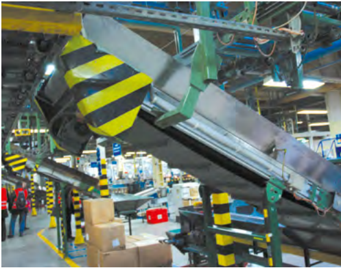
Rys. 77-1. Oznakowane (żółto-czarnymi ukośnymi pasami) elementy obniżające wysokość przejścia (a, b, c, d); miejsca stwarzające zagrożenie urazem głowy oznakowane dodatkowo znakami ostrzegawczymi: niebezpieczeństwo uszkodzenia głowy (a) i ograniczenie wysokości przejścia do wysokości 1,8 m (b)
