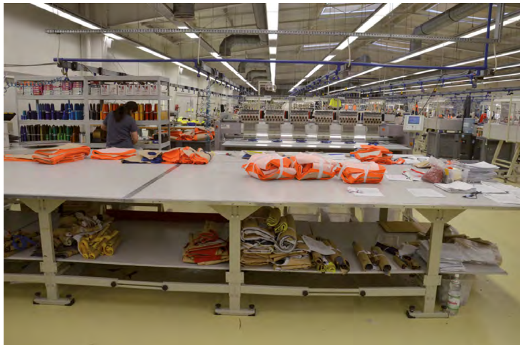
Rys. 29-1. Bezołnieniowe oprawy oświetlenia ogólnego z możliwością załączania poszczególnych sekcji
