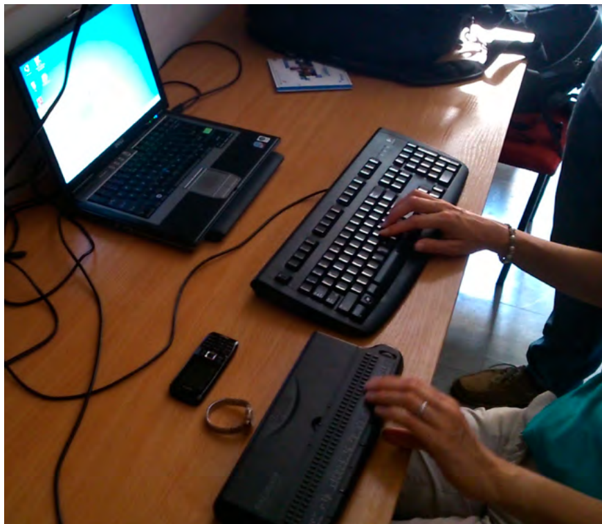
Rys. 49-1. Stanowisko komputerowe wyposażone w oprogramowanie wspierające obsługę komputera mową syntetyczną i alfabetem Braille'a oraz monitor brajlowski
