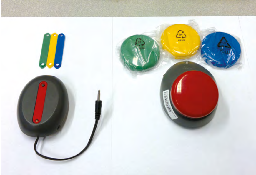
Rys. 63-1. Zdalne przyciski: a) nadajnik, b) odbiornik i nadajnik (różne kolory przycisku)
