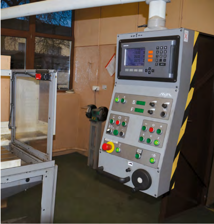
Rys. 73-1. Elementy konstrukcyjne maszyny wystające poza jej obrys, oznakowane barwą bezpieczeństwa
