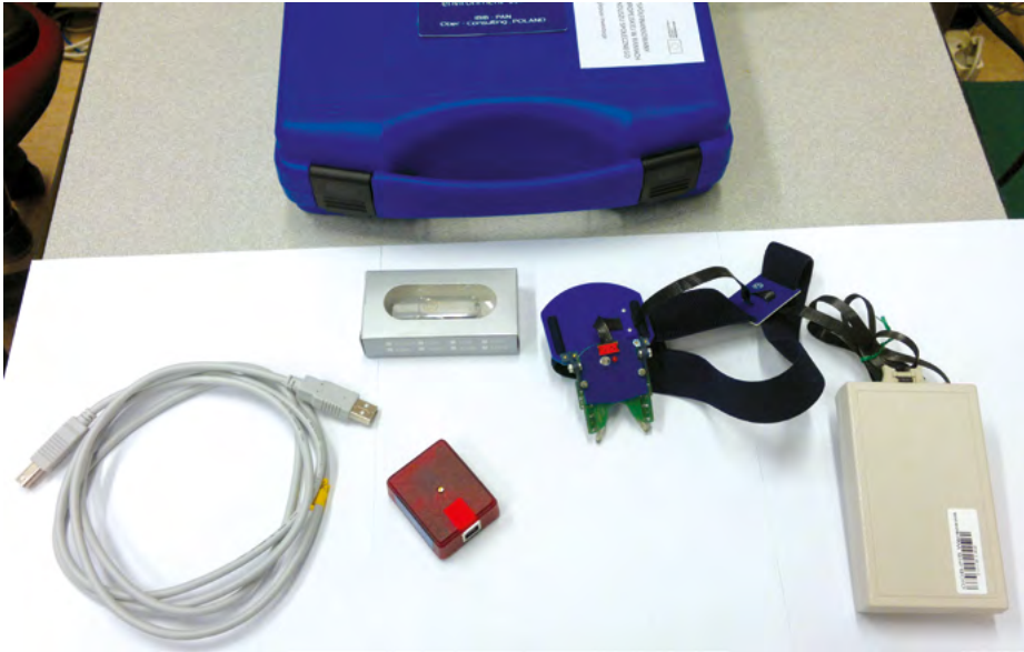
Rys. 64-1. Urządzenie do rejestracji ruchu powiek lub głowy
