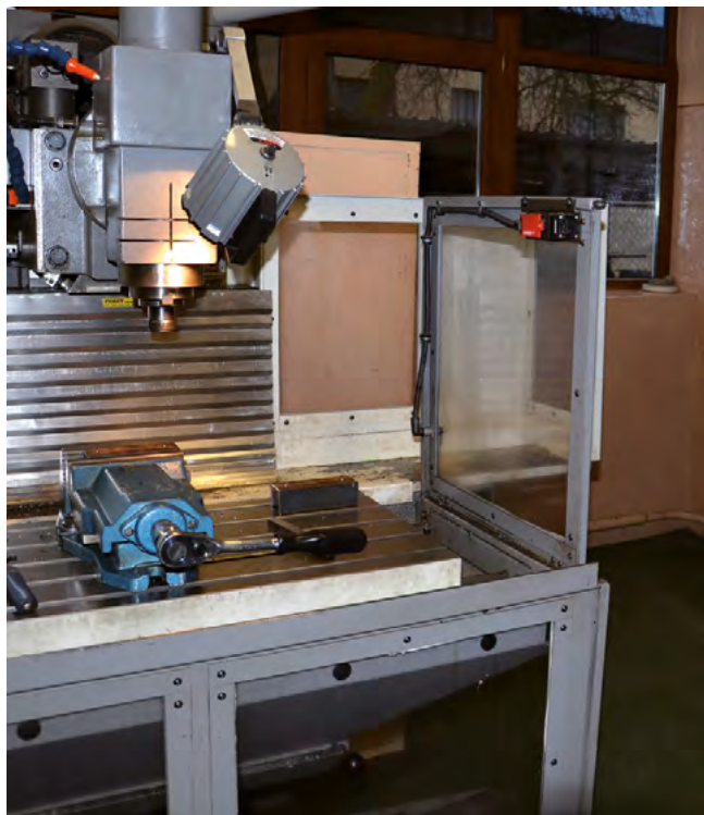
Rys. 35-1. Zastosowanie oprawy oświetlenia miejscowego do doświetlenia obszaru stanowiska pracy
