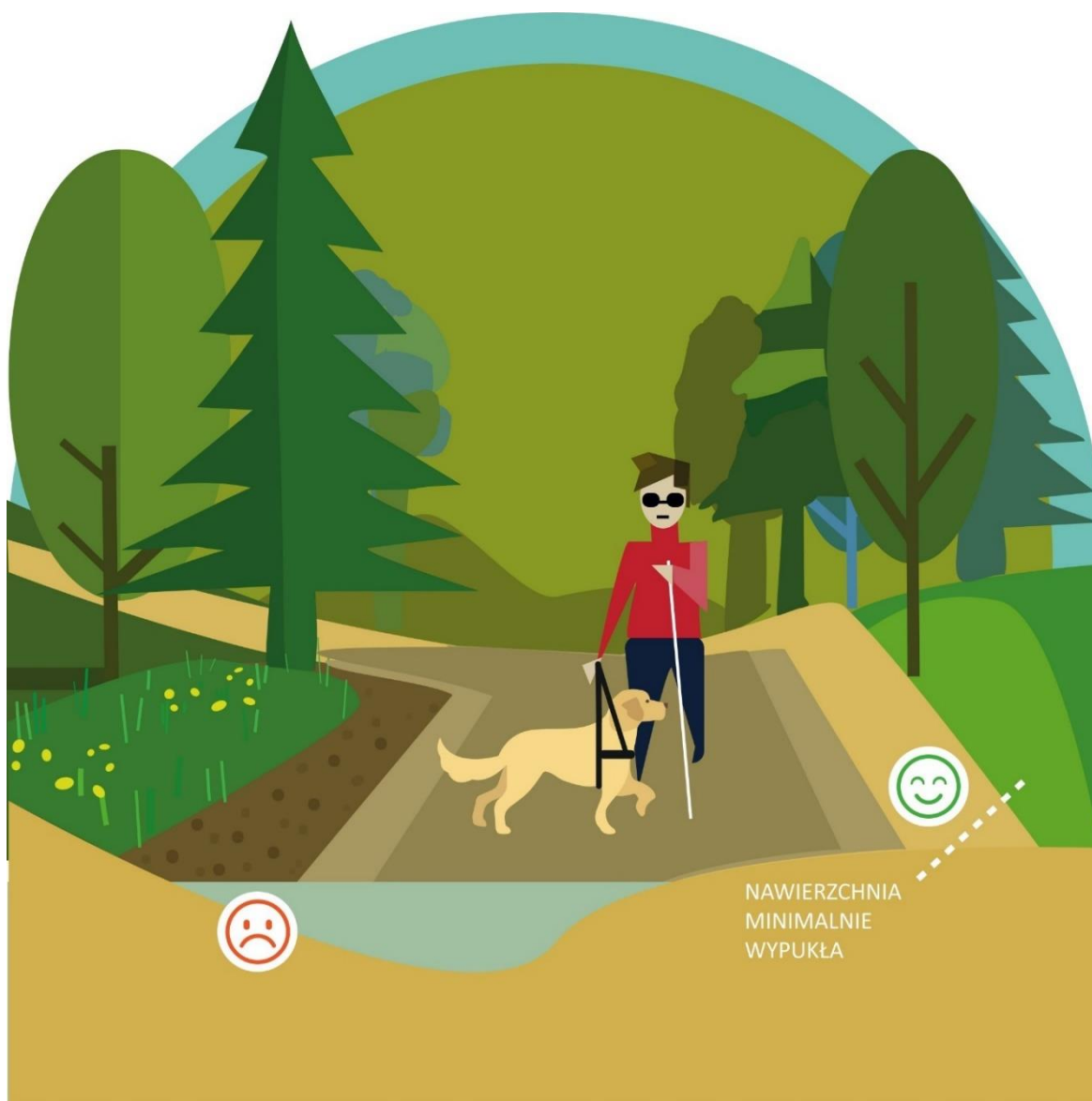
Profil poprzeczny dostępnego szlaku turystycznego
