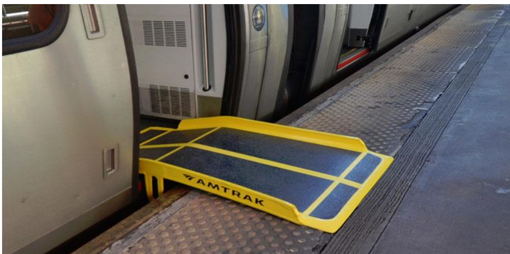
Rys.55. Widok zamontowanego pomostu na peronie wyższym od podłogi pojazdu
